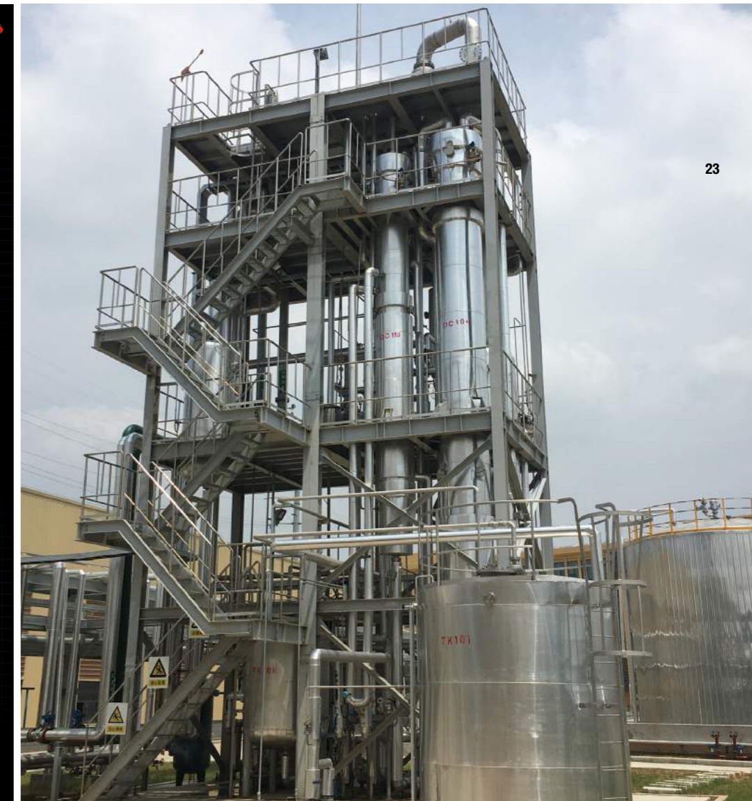
중국 H사에 공급된 웰크론한텍 분리막 용제회수설비(MC Distillation LP Refinery System)
